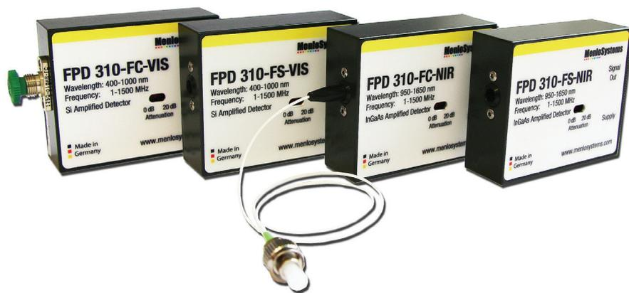
高感度超高速PIN光検出器FPD310製品ファミリーは、高利得、高帯域幅、極めて短い立ち上がり時間、高い信号雑音比を実現するために最適化されています。これらの光検出器は使いやすいSiまたはInGaAs-PINフォトダイオードパッケージで、高利得、低雑音の高周波増幅器が内蔵されています。利得は2つの固定値 (0 dBおよび20 dB 減衰)の間で切り替えが可能で、用途に最適な性能をご提供致します。
