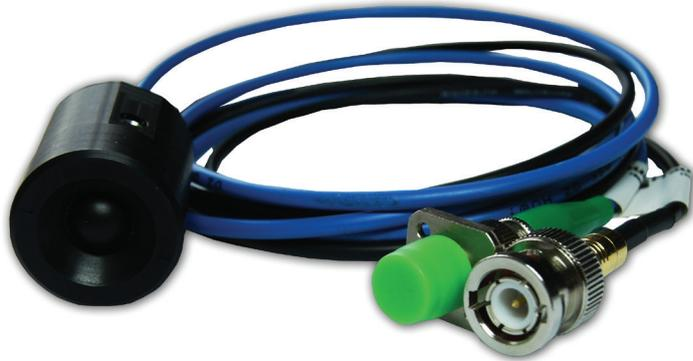
适用于1560 nm激光器的光纤耦合型 TERA15-FC 太赫兹天线模块是针对我们对灵活而可靠的全光纤太赫兹时域光谱系统而开发的独特解决方案。得益于InGaAs/In-AlAs多层Mesa结构和发射器所加高偏置电压保证高功率太赫兹输出，对发射器和探测器结构最优化亦为最高太赫兹带宽提供了保证。保偏光纤耦合确保器件即使在恶劣的环境下仍能可靠而稳定运行。
