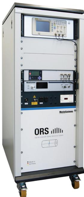
光学参考系统(ORS)能够提供一束具有超窄线宽和短时超高稳定性的单色连续光输出。此系统主要包括一台稳定锁相到超高精细度光学腔的连续激光器，该光学腔由超低膨胀系数(ULE)的玻璃制成。系统紧凑的设计将高真空，恒温，隔振和声学隔离等各单元集成到一个19"机柜中，确保输出激光源的超窄线宽和超高稳定性。此外，系统为长距离运输设计了特殊的机械锁定装置，保证在系统运输至目的地时，无需重新调节光束与光学腔之间的耦合。在出厂前每台光学参考系统必须与另一套参考系统相互比对以通过各种苛刻性能测试，确保出厂指标稳定优异。
