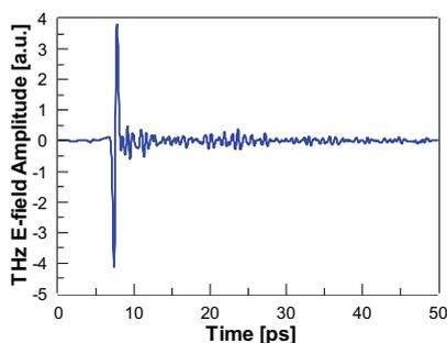
THz光谱显示大气水蒸气的吸收线
