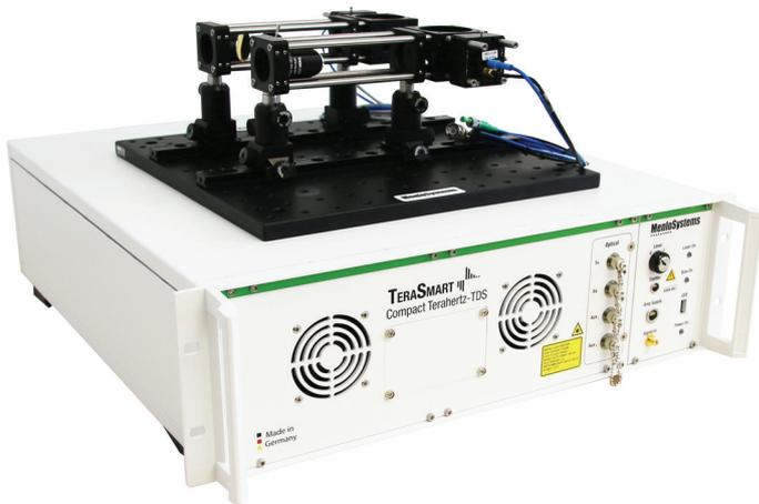
Menlo Systems的新型紧凑型太赫兹光谱仪TeraSmart为高速宽频时域THz光谱测量提供了一键启动式解决方案。它结合了配备Menlo Systems最新独有的Figure 9®锁模技术的飞秒光纤激光源及业界认证的THz部件。TeraSmart基于模块化的OEM激光平台保证了其在任何工业或科研环境下的出色可集成性与高度灵活性需求。例如长度可定制的光纤耦合天线，配置额外光源输出口的一台ELMO支持TeraSmart实现多通道同时测量。系统提供智能TCP Socket接口配置通过以太网支持将TeraSmart与现有实验系统或者在工业无损探伤(NDT)系统连接进行远程操控与无缝集成。简而言之，一键启动，适用于OEM可集成化的TeraSmart专为全天候24/7稳定运行而设计。
