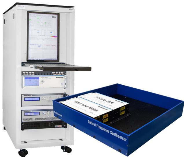
FC1500-ULN<sup>nova</sup> 是 Menlo System 最新型的具有终极性能的光学频率梳系统，它的核心包括基于超低噪声（ULN）Fiugre<sup>®</sup>锁模专利技术的，代号为“Nova”的光梳振荡器。此振荡器的强化设计使Nova稳健性大为提高，保证了Nova对声学噪声和热漂移极其不敏感。Nova自由运行时单个梳齿线宽仅为15 kHz，确保FC1500-ULN<sup>nova</sup>支持10<sup>-19</sup>量级\*的频率稳定度（平均时间为1秒）。
