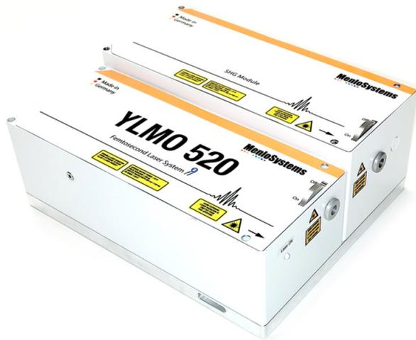
YLMO 520 基于一台倍频的掺镱飞秒光纤激光器（YLMO）。该系统在520nm处提供超过 500mW 的平均输出功率，脉冲宽度小于150 fs。一该系统允许同时输出1040nm的基频光并可任意调节 520/1040 nm 的功率比。峰值功率高，稳定性极好，长期性能可靠等优点使得 YLMO 520 完美地适用于多光子激发、泵浦探测光谱或双光子聚合等应用。Menlo Systems 的飞秒光纤激光器整合了光纤技术的最新发展，并将这些改进纳入了一个易于使用的产品。
