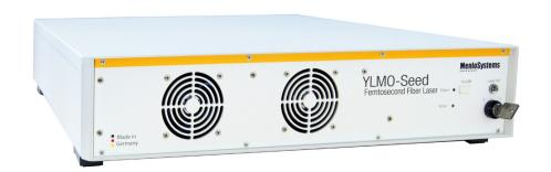
MenloSystems基于掺镱飞秒光纤激光振荡器集成了光纤技术的最新发展,并将这些增强功能整合到了易于使用的产品中。我们的专利Figure9®技术提供稳定可靠和长期一致的锁模,确保在苛刻环境中长期稳定运行。即使在温度波动大的恶劣环境中,保偏光纤的设计也可确保出色的稳定性和低噪声。作为放大器的种子源,YLMO-Seed提供易于集成和免维护的操作,专为24/7全天候不间断操作而设计。
