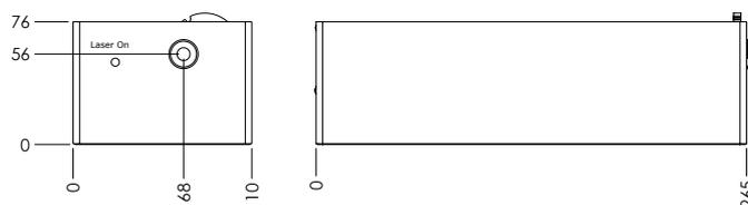
YLMO激光头的技术图纸。激光头配有可拆卸的25 mm 高的光学接杆和叉式压块。请与我们联系以获取更多详细信息和控制单元的技术图纸。
