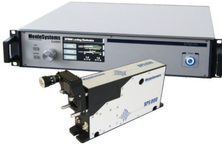
XPS800飞秒相位稳定单元能够控制超短脉冲的载波与包络之间的相位关系。来自飞秒激光的脉冲在非线性光子晶体光纤（PCF）中被展宽以实现跨倍频程光谱。利用一个非线性干涉仪可将此光谱中红外部分的二倍频光和绿光进行拍频，得到偏移拍频信号，此信号被反馈到稳相电子装置中，该稳相电路将偏移拍频信号频率锁定为振荡器重复频率的1/4大小。这样每相隔四个脉冲就有相同的相位。利用后续的放大器系统能够将这些脉冲放大而无相移的输出。
