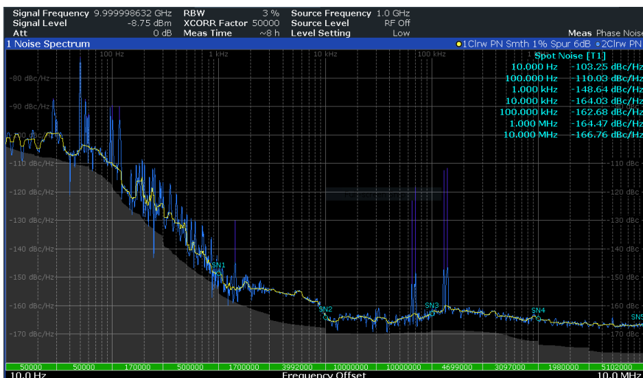
10 GHz 载波信号的受测量仪器限制的相位噪声轨迹。
